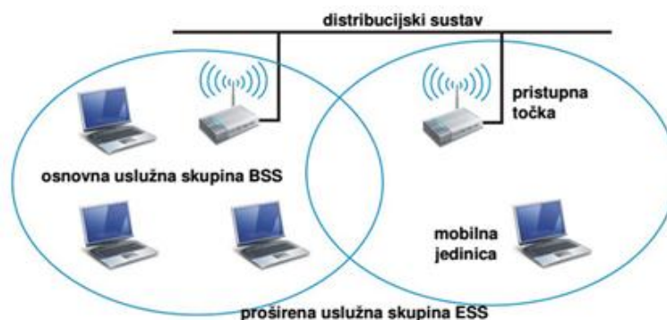
Slika 7.3. Infrastrukturni način rada WLAN mreže
